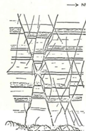
Figur 15. Skitse af fjeldside med X-formigt forkastningssystem.
