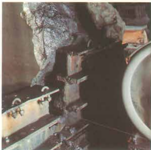
Nærbillede af savningen. Den endeløse, snoede tråd trækkes af forskellige drivhjul, hvoraf eet ses til højre. Den 5 cm tykke plade er næsten frisavet.
