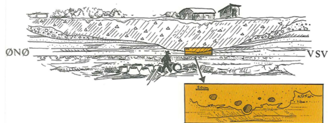
Figur 5. Skitse af de geologiske forhold i en husudgravning på Lykkensdalsvej 8. Øverst markeret med trekanter og skråstreger ses moræneler. Dette skærer ned i grovt grus og lagdelt krydslejret sand, der også indbyrdes afskærer hinandens lagdeling. Nederst i profilet fandtes et lag med stærkt foldede finkornede sandede og lerede aflejringer. Indramningen viser en detalje fra grænsen mellem moræneler og sand, der var stærkt uregelmæssig uden at lagdelingen i sandet var forstyrret. De skraverede klatter angiver beliggenheden af sten i moræneleret.
