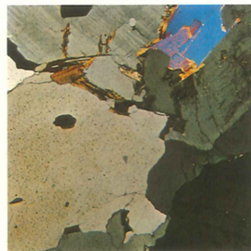
Figur 3b. Granit fra Østfold, Norge. Graniten indeholder store korn af kvarts (nederst til venstre), plagioklas (øverst til venstre), samt mikroklin (nederst til højre) og muskovit (grålig) og biotit (brunlig) mellem kvarts og mikroklin.
