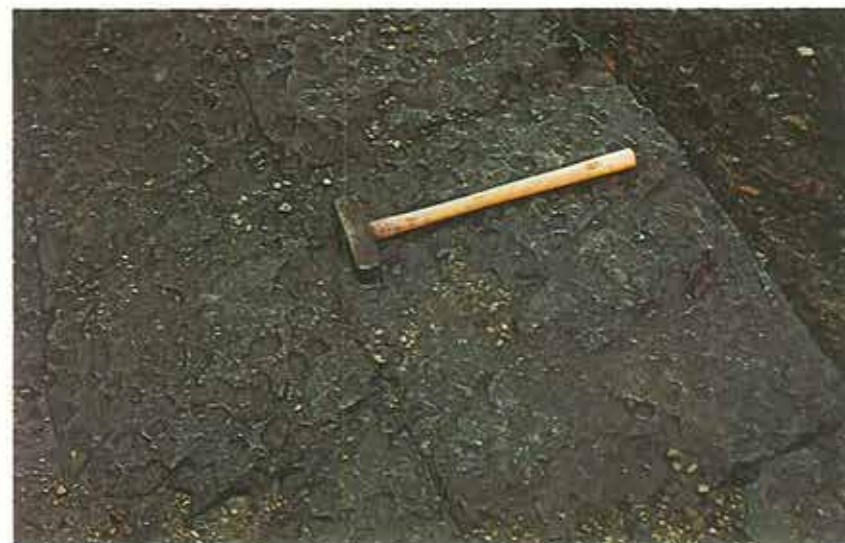
Figur 7. Sort kvartssandsten. I gruberne på lagfladen har der siddet omlejrede små flager af lerskifer. Balka-sandsten, Pedersker.
