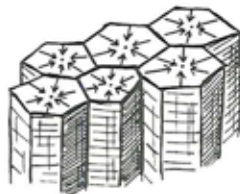
Figur 6. Dannelse af søjlestruktur i basalt ved sammentrækning under afkøling.
