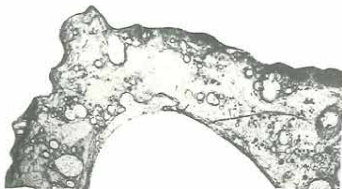
Figur 2. Udsnit af væggen af lynørret i figur 1 set under stor forstørrelse. Vægtykkelsen er 1 mm. Glasmassen fremtræder som strukturløs, glasboblerne er hvide og afrundede. I venstre, ydre kant ligger et ikke-smeltet feldspatkorn (foto M.Ghisler).
