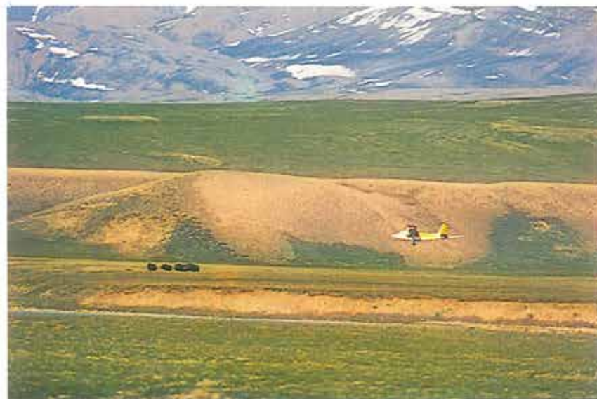
Figur 4. Ved flymåling af jordens radioaktivitet flyves der langsomt i lav højde over terrænet. Bemærk moskusokserne på jorden foran flyet. I den lange bom bagest i flyet sidder sensoren ("føleren") til magnetiske målinger, der udføres samtidig med de radiometriske.
