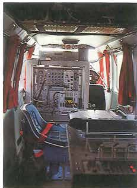
Figur 3. Gammaspektrometeret, der anvendes i Østgrønland, er installeret i et fly af typen Britten-Norman Islander. Detektor-krystallerne er monterede i den grå kasse i forgrunden.
