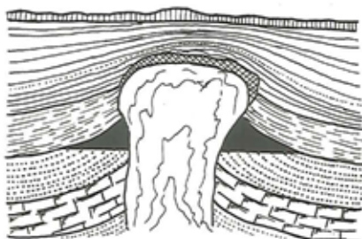
Olie opfanget i opbøjede lag langs saltdiapir.
