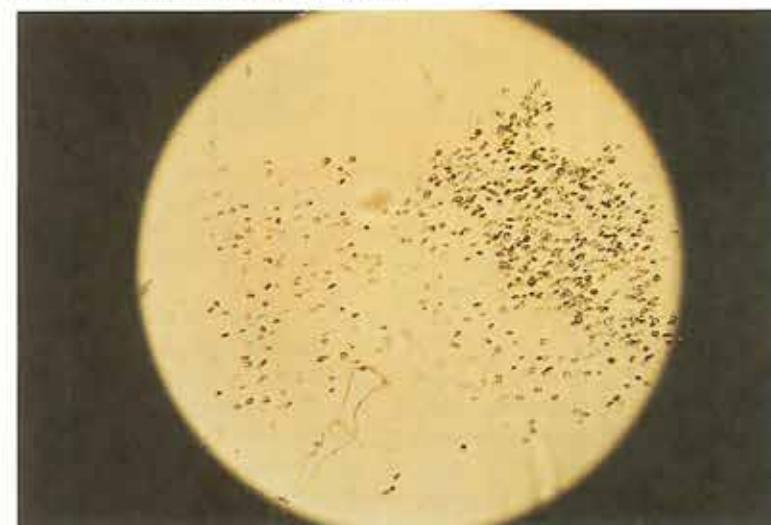
Glimmerblad med fissions-spor, svarende til udsnittet ovenfor. I det friske eudialyt korn ses en jævn fordeling af spor, det vil sige, der er en jævn fordeling af uran. I det højre korn ses koncentration af spor og dermed uran i den forvitrede halvdel. I områder med arfvedsonit og mikroklin ses ingen spor, det vil sige, disse mineraler indeholder ikke uran.
