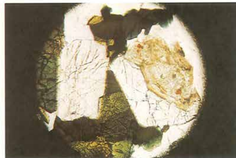
To eudialyt korn, det venstre frisk det højre delvis forvitret. De grønne korn er arfvedsonit og det lyse øverst i billedet er feldspatten mikroklin. Diameteren i begge billeder er 1 mm.
