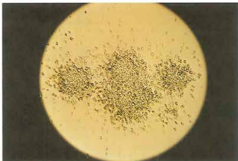
Glimmerblad svarende til billedet ovenfor. Man ser tydeligt, at uran er koncentreret i thorit mineralet, hvorimod albit (en feldspat) er uranfri.
