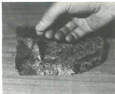
Figur 3. Den tørre peel løsnes i et hjørne ..
