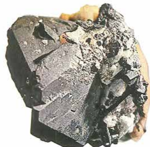
Krystal af mineralet steenstrupin, det vigtigste uranholdige mineral i malmen fra Kvanefjeld (foto Geologisk Centralinstitut).
