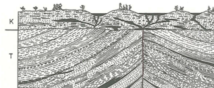
Figur 4. Skematisk snit gennem jordlagene ved Rancho la Brea. I de foldede og forkastede sand- og gruslag fra Tertiærtid (T) er mere porøse lag mættet med olie. I Kvartærtid (K) på godt 50 m er de tidligere oliepøle ved afgasning og tab af mere flygtige kulbrinter blevet til hård asfalt. Flydende asfalt ses som pøle og søer i den nuværende landoverflade. Modificeret efter Arnold.
