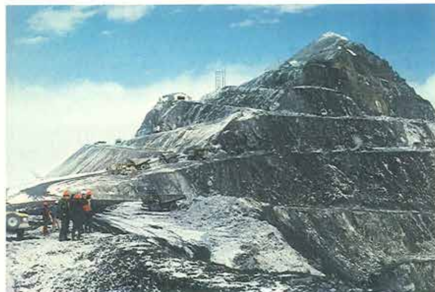
En åben mine behøver ikke at gå ned i jorden. I Cassiar minen i British Columbia (Canada) fjerner man en hel bjergtop af serpentinasbest. S.Laufeld foto.
