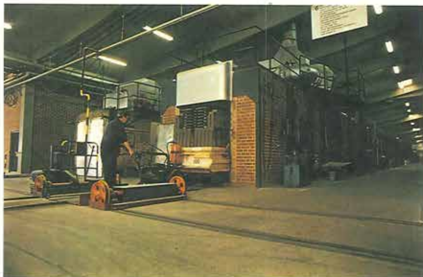
Figur 2. Ildfaste sten brændes i tunnelovne ved temperaturer mellem 1350° og 1750°C som her i Bjuvsværket, Höganäs AB.
