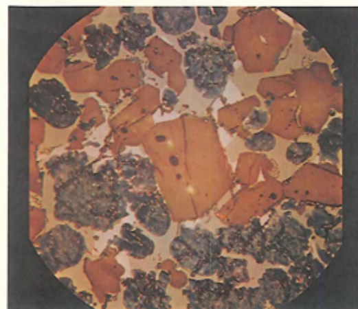
Figur 4. Cementklinkers mineraler. Efter ætsning af et polerslib kan man tydeligt skelne mellem de to vigtigste calciumsilikater. Alit (gul) og Belit (blå), som ligger i en smeltemasse af calcium-jern-aluminat. Belitkrystallerne er omkring 10 µ i diameter.
