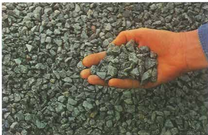
Fig. 8. Rønne granit skærve granulat. A) 35/35 mm skærver til jernbane svellefundament. B) 8/18 mm skærver til vejbelægning.
