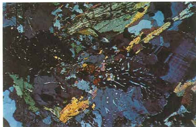
Fig. 4. Tyndslib af Rønne granit, krydsede polarisatorer. Stærkt farvet minera-ler er henholdsvis hornblende og biotit, mørkegrå og lysegrå mineraler er feld-spat og kvarts. Bemærk den "orm-agtige" myrmekeit tekstur, der skyldes sam-menvoksningen mellem kvarts og mikroklin.
