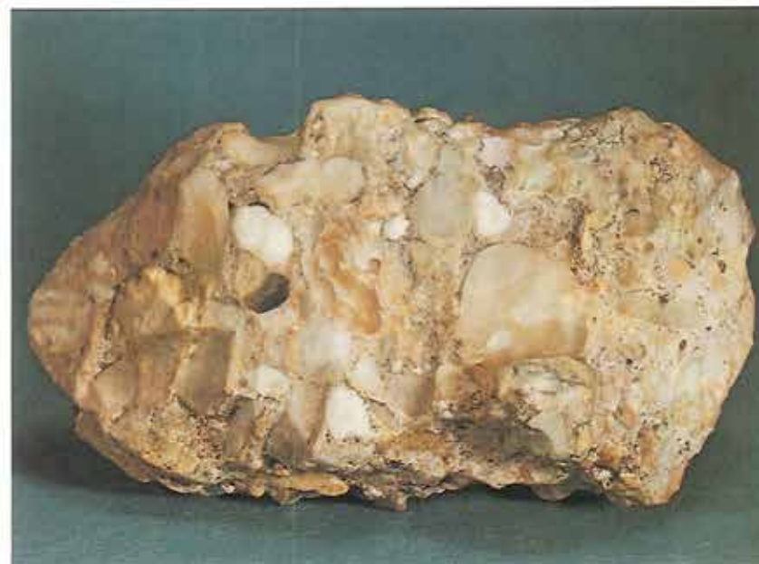
Figur 3. Flintkonglomerat fra Vestjylland. Der ses mange helt afrundede kvartsitrullesten. Grundmassen er sandet med enkelte gruskorn. Fofo: Ole Bang Berthelsen.
