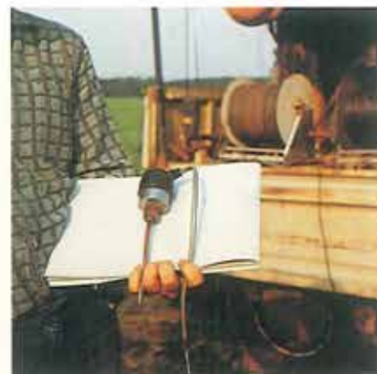
Figur 3. Sprængningerne registreres af geofoner, der er anbragt langs profilinien. Her ses en geofon, parat til placering.
