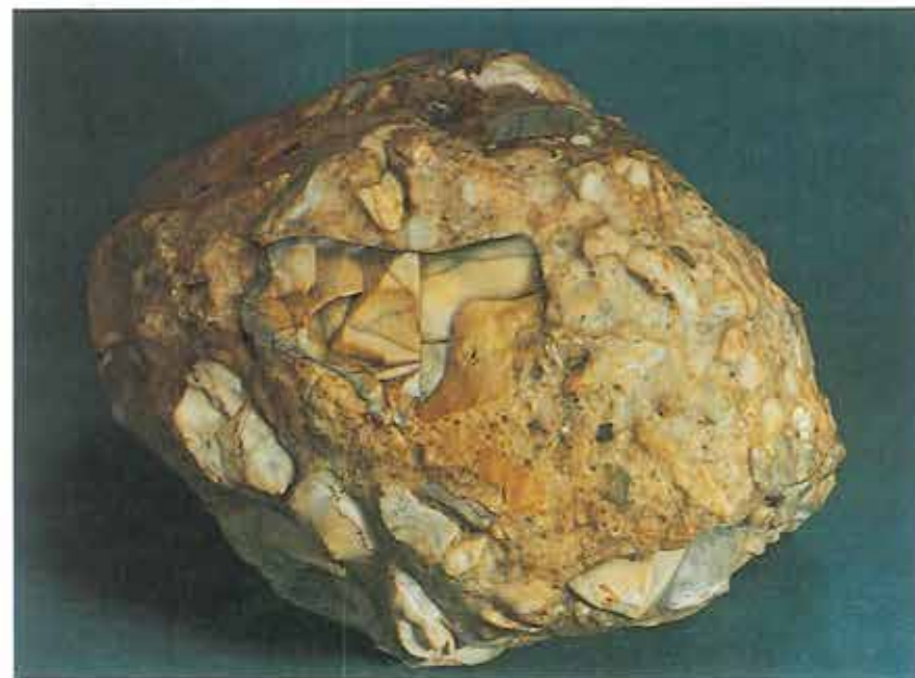
Figur 1. Flintkonglomerat fra Vestjylland. Flinten er afrundet og indlejret i en småstenet, sandet grundmasse. Det viste flintkonglomerat er ca. 25 cm bredt. Foto: Ole Bang Berthelsen.
