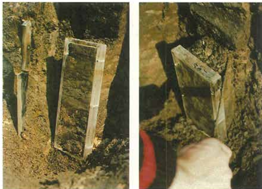
Figur 2. To trin i prøveudtagningen. Til venstre er prøvens omrids friskåret og prøveklodsens netop påsat. Til højre er udskæringen fortsat, og prøvens bagside er næsten frigjort.
