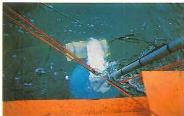
Figur 3. Pingersystem monteret på miljøstyrelsens skib "Marie Miljø". På den tragtformede pinger er der monteret en ekstra undervandsmikrofon (hydrofon), den gule cylinder, midt i billedet. Foto: Birte H. Marker.
