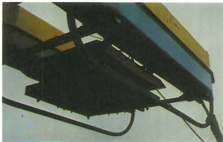
Fig. 5. Boomer. Lydkilden (transducere) er en stor elektromagnet monteret mellem pontoner.
