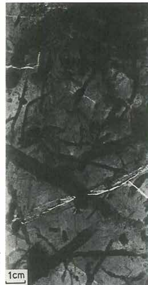
Figur 4. Røntgenoptagelse af et mere sandet lag i Hodde Leret, hvor gravegangene er kraftigere udviklet.
