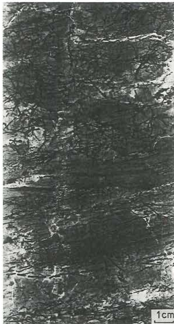
Figur 3. Røntgenoptagelse af Hodde Ler. Der ses mange svovl-kis-udfyldte (mørke) gravegange, både af den fine trådede og af den tykkere stænglede type. Lagdeling (næsten vandret) kan også skelnes.
