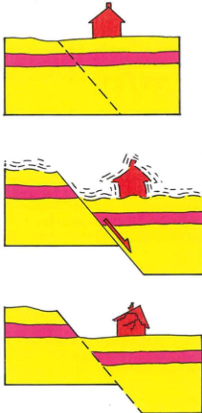
*Figur 1. Jordskælv opstået ved normalforkastning. Størstedelen af denne type jordskælv starter ved basis af den sprøde øverste del af jordskorpen i ca. 6-12 km's dybde, og hyppigst vil forkastningsplanet hælde mellem 30 og 60 grader.*
