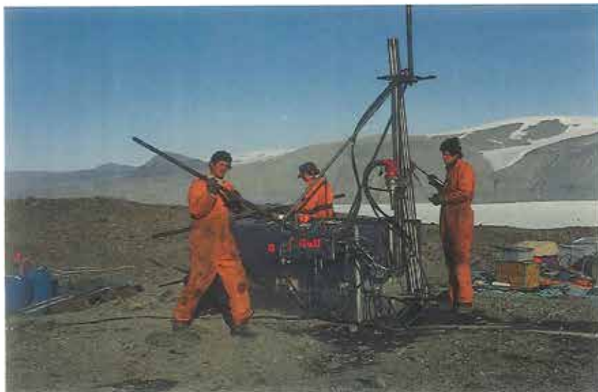
Figur 2. Boring med GGU's kerneboringsudstyr.
