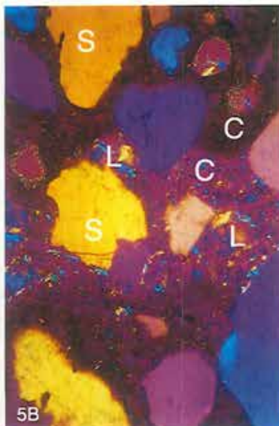
Figur 5. Tyndslidsbilleder af revnet beton. A: set i almindeligt gennemfaldende lys. En revne ses på grund af limens indhold af gult farvestof. Tæt ved revnen ses en farveændring i pastaen, der her indeholder mere farvestof. I to luftporer ses radiært stillede nåleformede krystaller. B: samme udsnit set i polariseret lys med gipsblad i strålegangen. Der ses en forskel i formen på CH-kornene i den smalle omdannede zone om revnen sammenlignet med den uomdannede pasta. De radiært stillede krystaller kan identificeres som Aft-fase. C: Samme udsnit set i fluorescerende lys. Ændringen i porositeten af den omdannede pasta træder nu tydeligere frem. S=sand, C=cementpasta og L=luftporer. Format: 1.08x0.75 mm.
