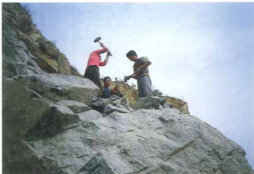
Figur 10. Meget af Kinas geologiske industri er helt på højde med den, vi kender fra vesten. Store maskiner flytter de brudte bjergarter, kilometerlange transportbånd og moderne oparbejdningsanlæg. I den situation forekommer det lidt mærkeligt at se, at hullerne til sprængladninger, der senere skal flytte tonsvis af sten, hamres ud ved håndkraft i stedet for at anvende boreudstyr. Hvor et trykluftbor kunne lave huller i løbet af en times tid, anvender flittige kinesere mange timer med mejsel og hammer.
