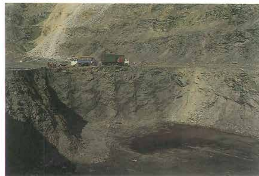
Figur 3. Azna collar åbne brud med ca. 20 meter massiv malm af den bandede type. Malmen udgør den mørke zone under lastbilerne.
