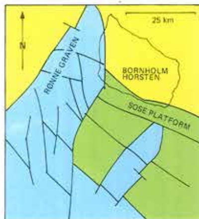
Figur 18. Blokmosaikken omkring Bornholm. Det blå felt omfatter de blokke, der havde den største indsykning i løbet af Mesozoikum. Det grønne område er blokke med moderat indsykning, mens gule felter viser blokke, der gennem Trias og Jura har ligget hen som horstområder.
