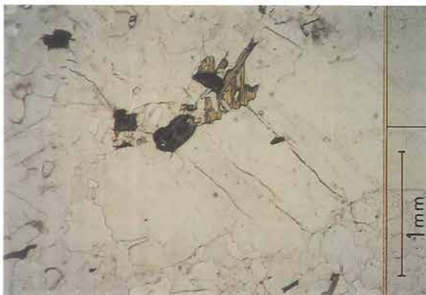
Figur 7. Et eksempel på hvordan et tungmineral, zirkon, forekommer som accessorisk mineral i en udgangsbjergart med kvarts og feldspat. Ved nedbrydning af moderbjergarten vil tungminerallerne have en større tendens til at overleve end mange af de andre tilstedeværende mineraler. Tyndslib af Hammergranit fra Bornholm.
