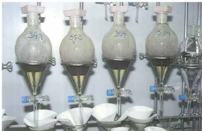
Figur 10. Tungvæskeseperation i DGU's sedimentlaboratorium. Separationen foregår i 500 ml skilletragte. Tungvæsken er bromoform, der foruden at være tung er temmelig giftig, så der arbejdes i stinksæk.
