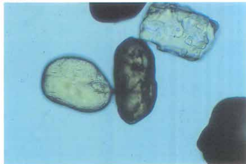
Figur 4. Pulverpræparat (Clearax n=1.66) med zirkon i midten flankeret af monazit til højre og staurolit øverst til venstre. Zirkonkornet er ca. 0.15 mm langt.
