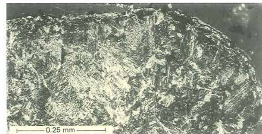
Figur 4. Afrundet stålfragment i den glasagtige bjergart. Kornet er 2.5 mm langt. Poleret prøve set i reflekteret lys. Herunder del af samme korn, nu med ætset overflade, som viser mikrostrukturer, der tillader bestemmelse af kornets opvarmnings- og afkølingshistorie.
