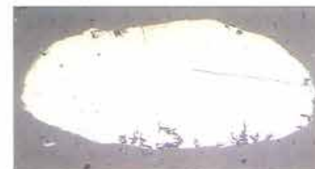
Figur 4. Afrundet stålfragment i den glasagtige bjergart. Kornet er 2.5 mm langt. Poleret prøve set i reflekteret lys. Herunder del af samme korn, nu med ætset overflade, som viser mikrostrukturer, der tillader bestemmelse af kornets opvarmnings- og afkølingshistorie.
