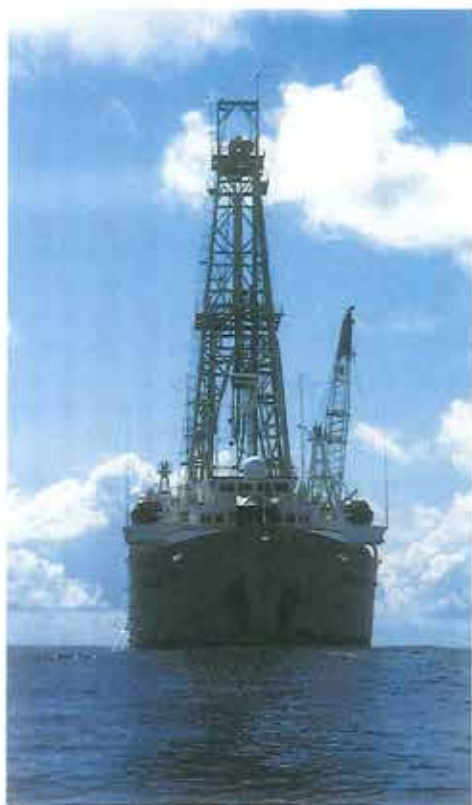
Boreskibet "Joides Resolution" kan bedst betegnes som et flydende forskningscenter med laboratorier bygget op i syv etager. Skibet er udstyret med et avanceret positioneringssystem, der selv i hård storm kan holde skibet stationært over et borehul på flere kilometers vanddybde.
