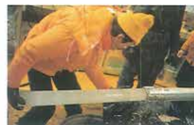
2 meter iskerne tages ud af det danske konstruerede bor ISTUK.
