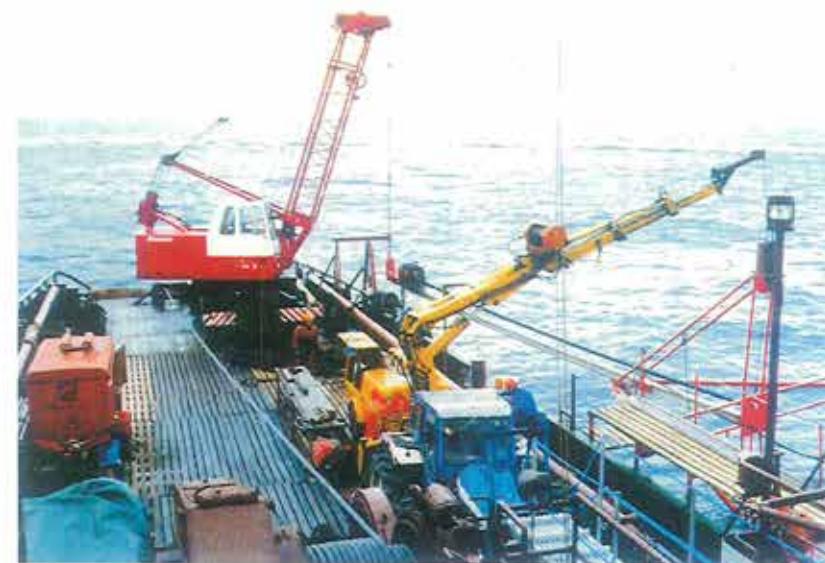
Dækket på boreskibet. Vibrocore boreriggen er udsendt mellem de to kraner.
