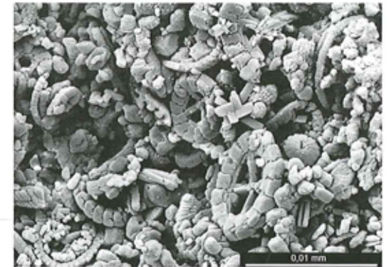
Figur 7. Skrivekridt set i elektronmikroskop. Man ser, hvordan kridtet er opbygget af kokkolither og plader fra kokkolither.
