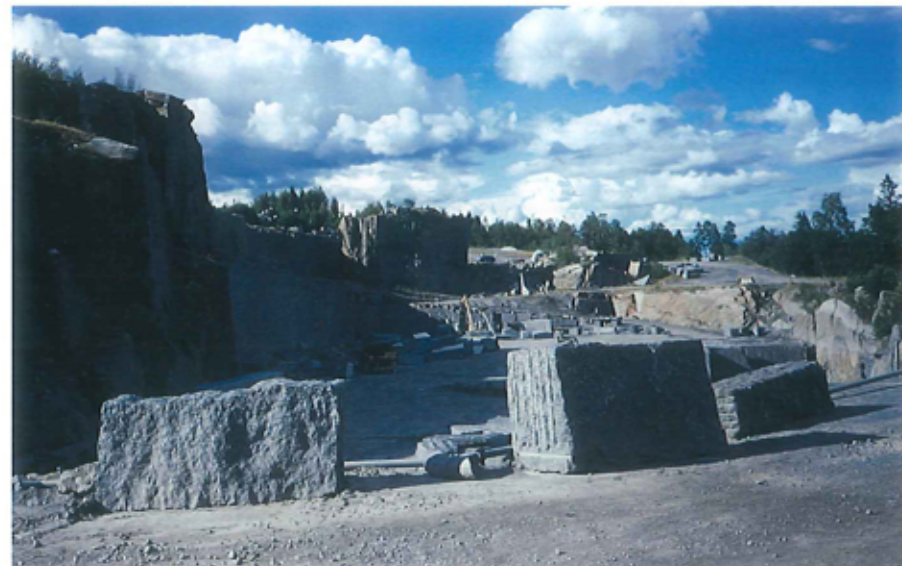
Larvikitbruddet ved Tjølling i Sydnorge. Larvikit sprænges ud i store massive blokke uden sprækker og skæres op i tynde plader, der poleres og anvendes som facaden.
