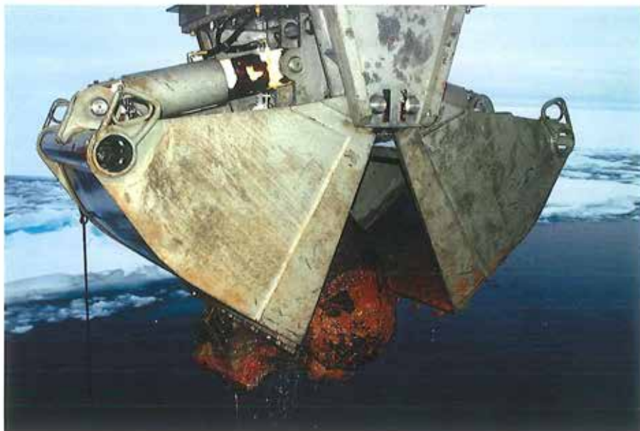
Figur 5. TV-styret griberedskab – et stort men meget virkningsfuldt redskab, som bruges til at optage prøver fra havbunden.
