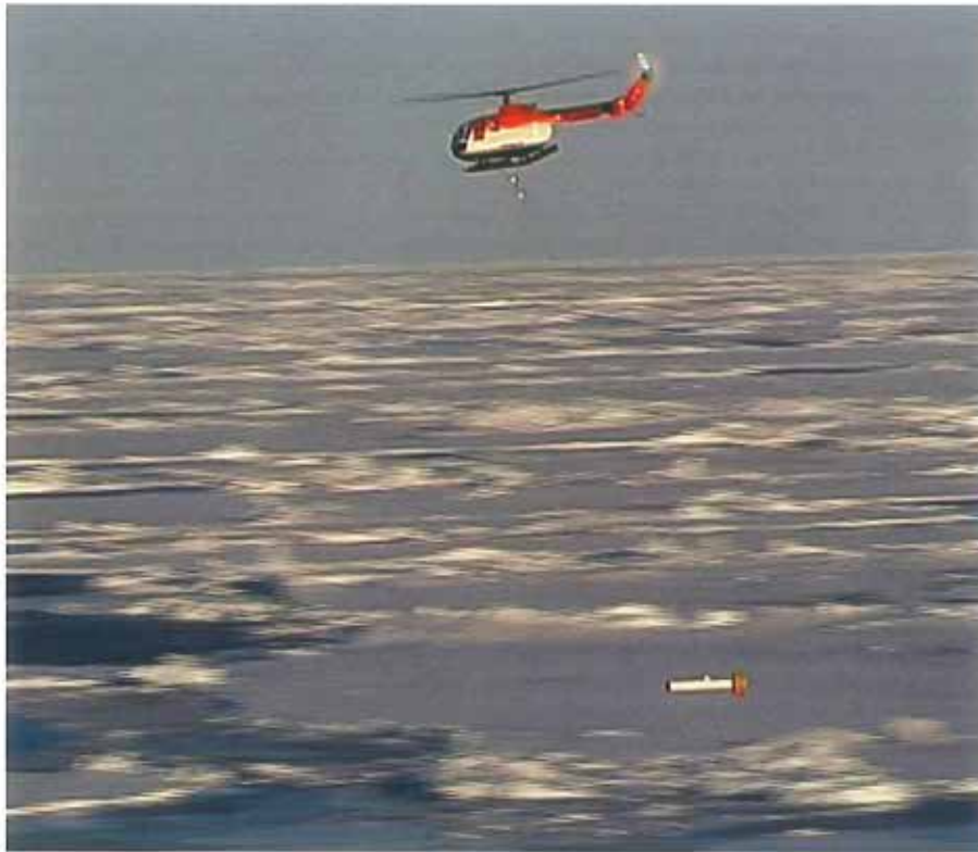
Figur 3. 'HEM-BIRD' (helikopter-elektromagnetik-sonde) flyves i en højde af ca. 20 meter over isoverfladen og bruges til indsamling af geofysiske data til bestemmelse af istykkelse.
