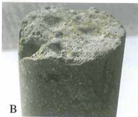
Figur 11. (a) En cylindrisk prøve af Midale Marly dolomit som den ser ud før et eksperiment. (b) Efter en måneds \text{CO}_2 -injektion ses der især i indløbsenden af prøven tydelig opløsning af bjergarten. Bemærk de små huller fra opløste mineraler. Der observeres også en stigning i prøvens porøsitet og permeabilitet under strømnings-eksperimentet. Prøvens diameter er 2,5 centimeter. (C) Scanning elektron mikroskop billedet viser en typisk Marly dolomit med veludviklede dolomitmikrokrystaller (do) samt lidt accessorisk alkalifeldspat (af) og pyrit. (D) Efter \text{CO}_2 -injektion er dolomit-krystallerne markant ætsede i indløbsenden, med en karakteristisk udvikling af udhulede krystaller. (C) og (D) er i samme skala (GEUS Kerne Laboratorium, 2003).
