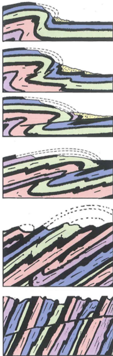
Figur 10. Kontinentale flager under sammenpresning. Modellen viser effekten af sammenpresning opdelt i seks trin. Digteriske tilføjelser forekommer i form af sedimenter og forkastninger: Man må forestille sig Bornholm til og med Ertholmene som et ca. 40 kilometer langt profil opbygget som næstsidste figur igennem trin svarende til de fire første figurer. Den sidste figur har for stejl hældning, men er med for fuldstændighedens skyld.
