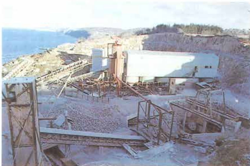
Figur 9. Ringebakke bruddet. Et transportbånd førte den knuste granit fra bruddet direkte ombord på skibene.
