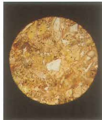
Figur 57. Grønsandskalk fra Lellinge set under mikroskop. Billedet viser skalrester, et skarpkantet kvartskorn og et grønt glaukonitkorn indlejret i en brun grundmasse af ler og kalk.
