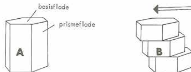
Figur 66. A. Idealiseret iskrystal med basis- og prismeflader. B. Krybning - glidning langs planer, parallelle med basisfladerne.
