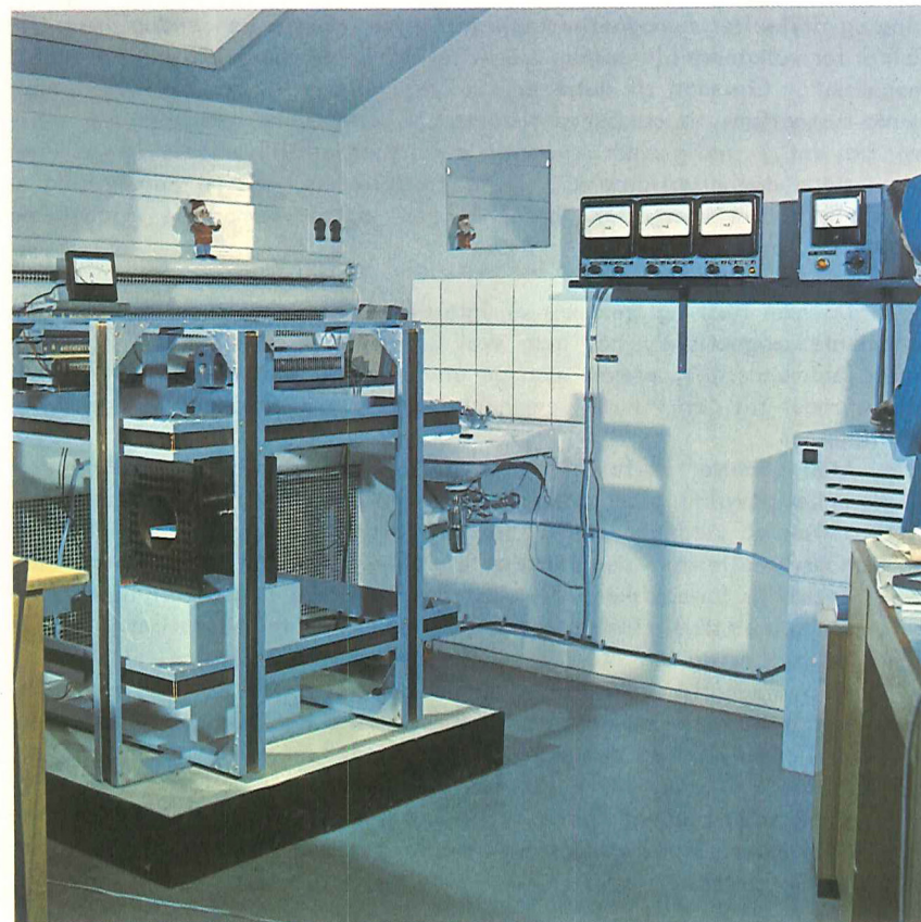
Figur 6. Apparat til afmagnetisering og magnetisk rensning. Palæo-magnetisk laboratorium ved Københavns Universitet.
