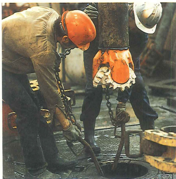
Det er meget vigtigt for borearbejdets gode forløb at værktøjet hele tiden er i allerbedste stand. Her monteres en ny boremejsel (tri-cone bit). (A.P.Møllers informationstjeneste)
