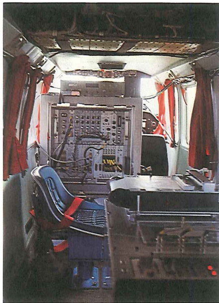
Figur 3. Gammaspektrometeret, der anvendes i Østgrønland, er installeret i et fly af typen Britten-Norman Islander. Detektor-krystallerne er monterede i den grå kasse i forgrunden.
