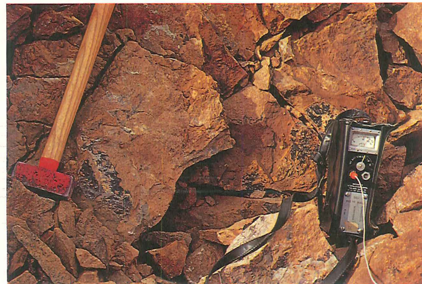
Figur 5. Uranmineraliseret flussspat-åre syd for Mesters Vig. Flussspaten er mørkviolet på grund af den radioaktive bestråling. Instrumentet er en af de typer feltscintillometre, GGU anvender.
