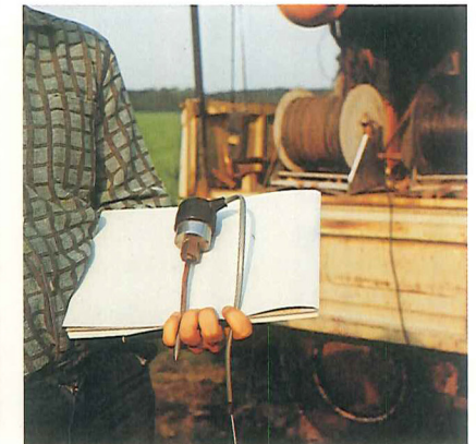
Figur 3. Sprængningerne registreres af geofoner, der er anbragt langs profilinien. Her ses en geofon, parat til placering.
