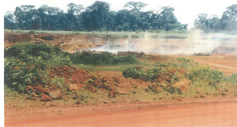
Figur 5. Bauxiten er stedvis meget hård og må derfor sprænges med dynamit som her i Awaso.
