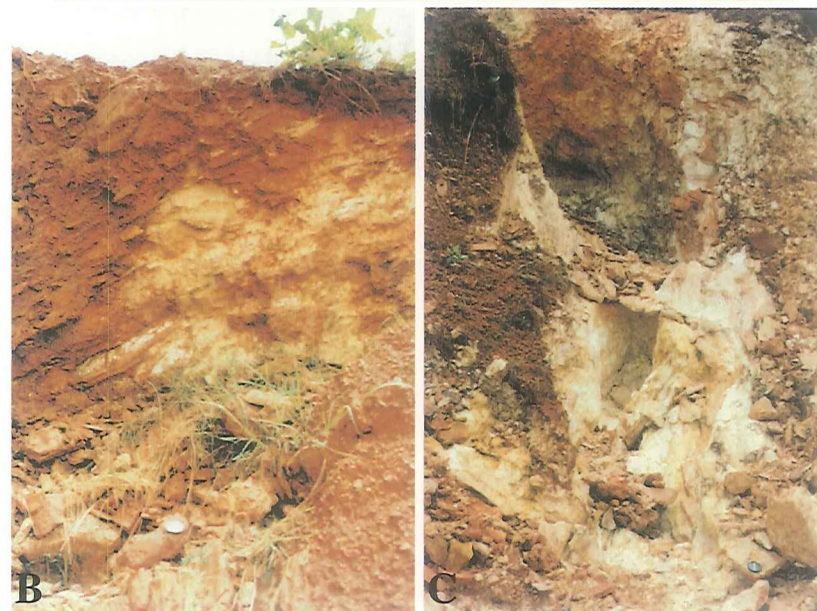
Figur 3. A) Nærbillede af bauxiten. B) Flammet bauxit. De røde og gule farver bruges som lødighedsindikatorer. Gule farver indicerer lidt jern og dermed meget aluminium. C) Nærbillede af overgangen mellem det phyllitiske udgangsmateriale og bauxiten.
