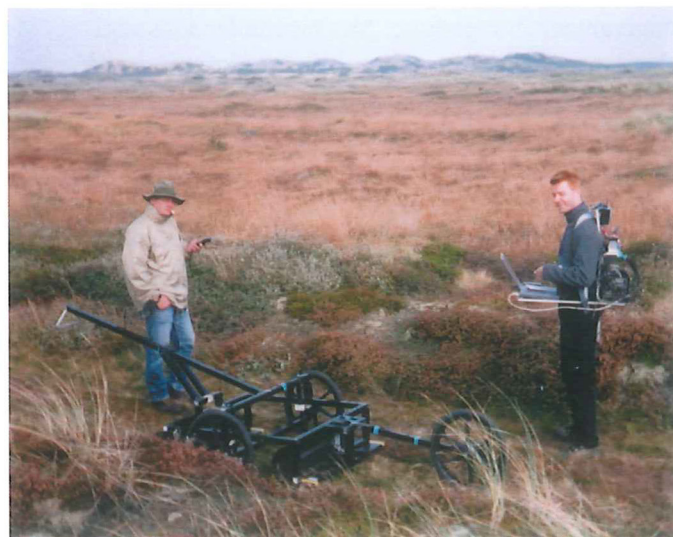
Figur 4. Opsætning af georadarudstyret, så det er klart til brug.
